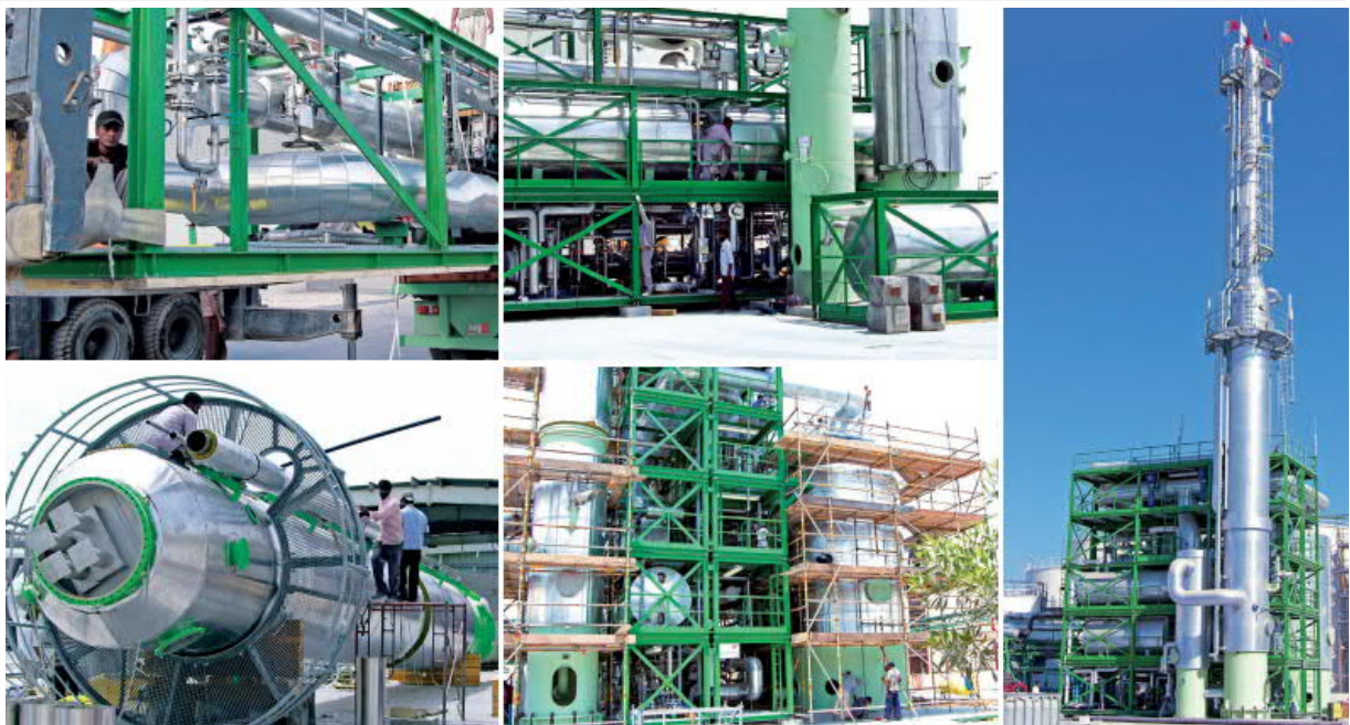
一个在巴林王国 Green Power WLL 运行的预组装单元。内含一个带加热器的精馏塔和分子筛。
